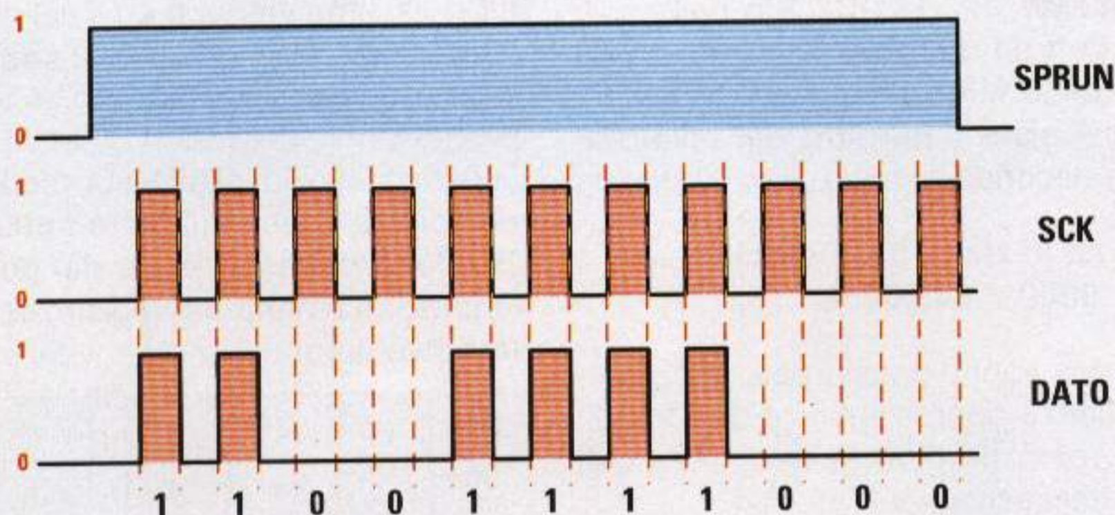
Fig.6 Diagramma di sincronismo SPI in cui abbiamo ipotizzato una trasmissione di 11 clock per ciclo. Con i primi 8 clock vengono trasmessi gli 8 bits contenuti nel registro spda, mentre per i successivi tre clock vengono trasmessi dei livelli logici 0. Poiché i dati, man mano che vengono ricevuti, shiftano nel registro spda del micro ricevente verso sinistra, dopo 11 clock il registro spda conterrà solo gli ultimi 8 bits trasmessi. La quantità dei bits da inviare deve essere identica alla quantità dei bits da ricevere, cioè i registri spdv del Master e dello Slave devono avere la stessa configurazione.
